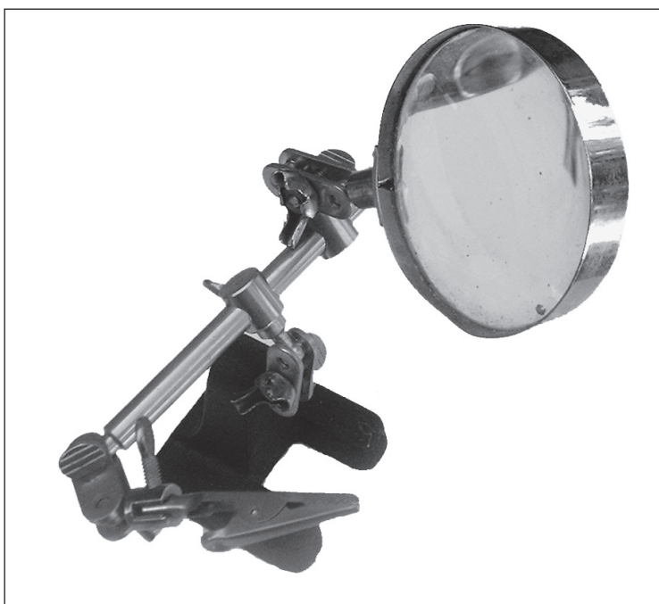
Figura 9-4: Essas mãos auxiliares combinam garras-jacaré com lentes de aumento.
