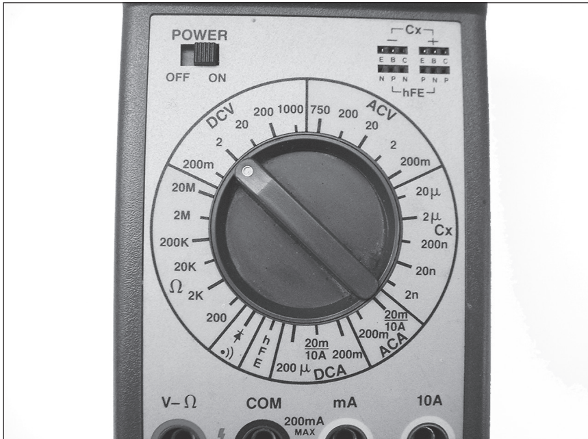
Figura 12-3: Multímetros digitais fornecem uma grande variedade de opções de medidas.
