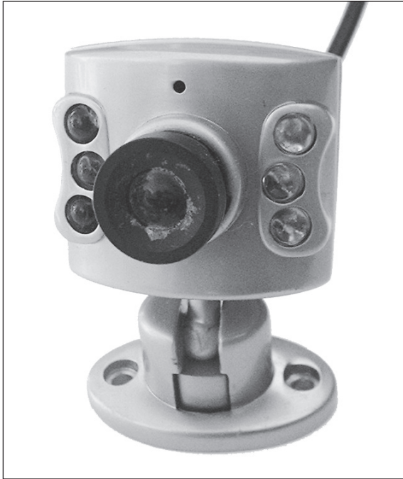
Figura 15-7: Esta câmera em miniatura pode ver no escuro, graças a seus seis diodos emissores de luz infravermelha (IR LEDs).
