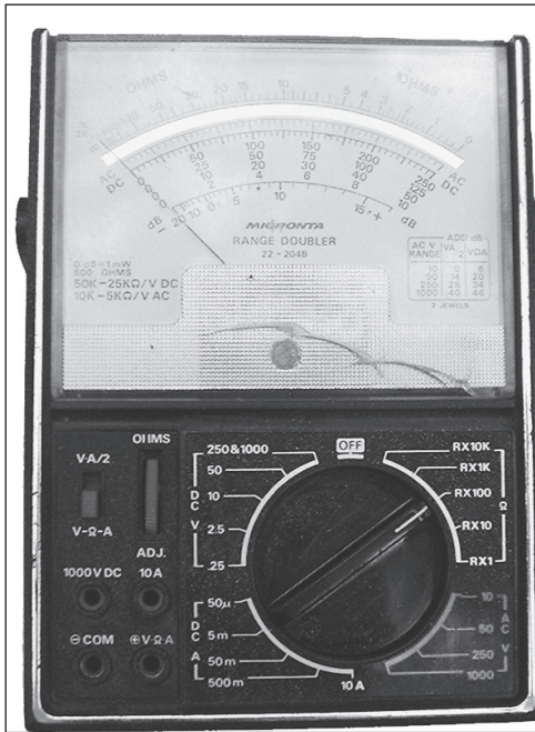
Figura 12-2: Um multímetro analógico usa uma agulha para indicar voltagem, corrente e outros valores.
