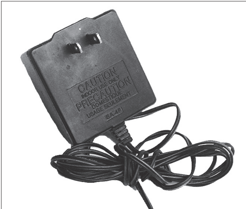
Figura 8-5: Um transformador de parede protege você da exposição à corrente AC da casa.
