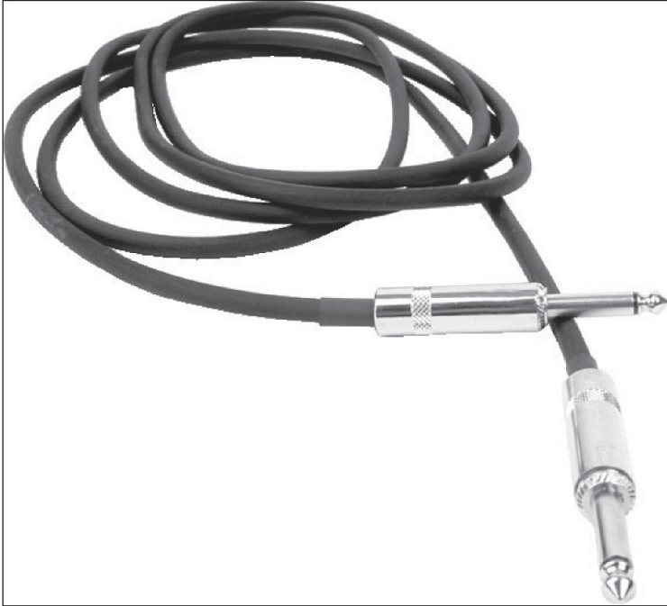
Figura 8-2: Um cabo com um plugue em cada ponta, conecta com soquetes montados em dois tipos de equipamentos eletrônicos.
