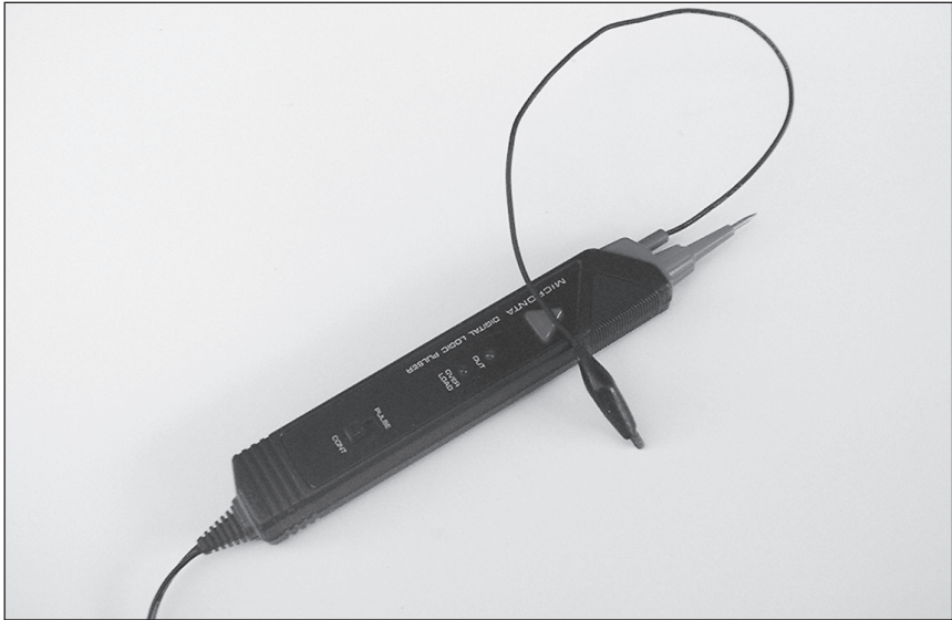
Figura 16-3: Um pulsador lógico insere um pulso de sinal ou um trem de pulsos em um circuito.
