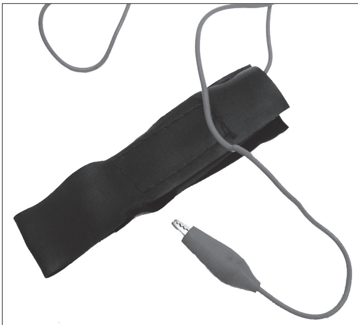
Figura 9-6: Uma pulseira antiestática reduz o risco de descarga eletrostática.
