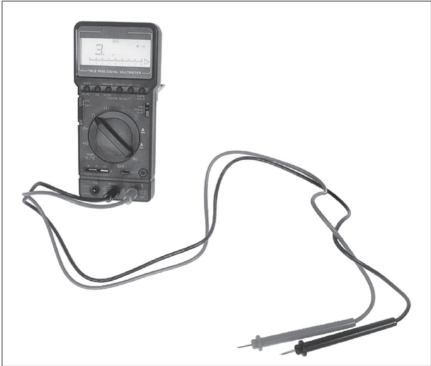
Figura 12-1: Multímetros medem voltagem, corrente, resistência e continuidade.
