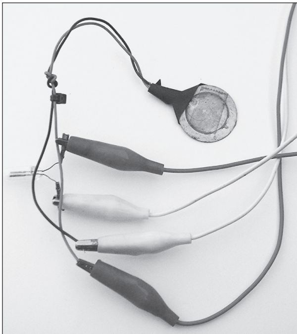
Figura 15-5: Conecte o disco e a lâmpada de néon utilizando garras jacaré.
