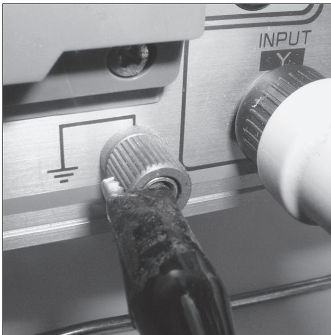
Figura 13-6: Junte o terra da sonda à conexão terra do osciloscópio.
